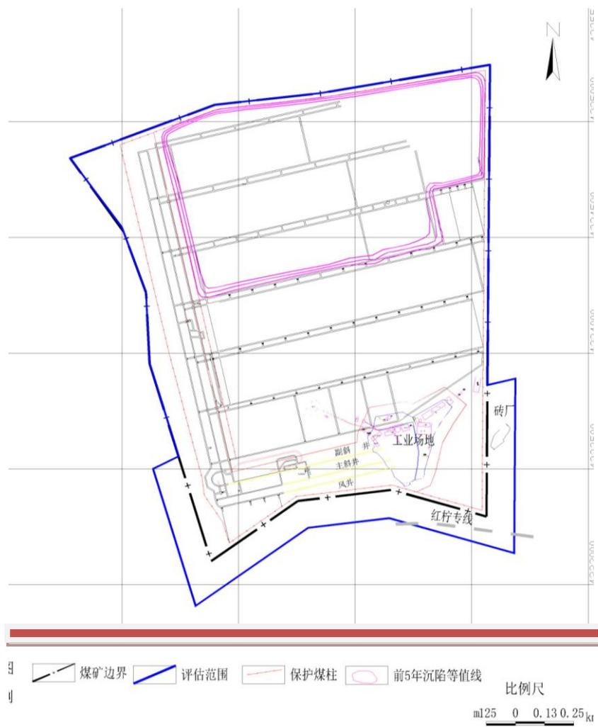
图 3.2-6 最近五年开采区地面塌陷等值线图
