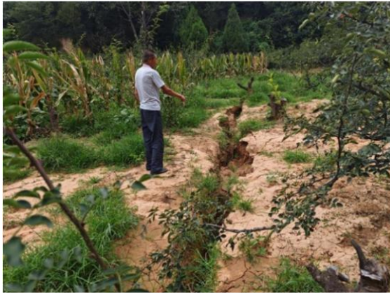
照片 3-6 LF12 现场调查（镜向：NW） 拍摄日期：2024 年 11 月 9 日 ②二三采区 23302 下 工作面地裂缝
