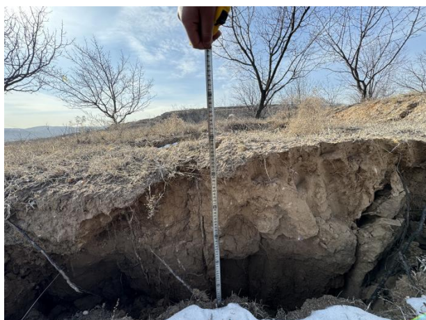
照片 3.2-14 裂缝深度测量（镜向南东）
