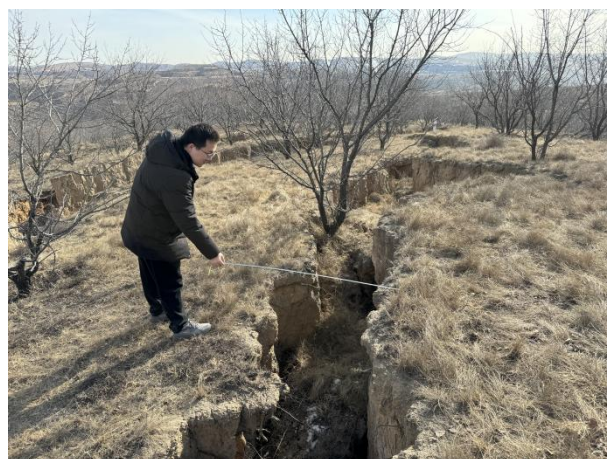
照片 3.2-15 裂缝宽度测量（镜向南西）
