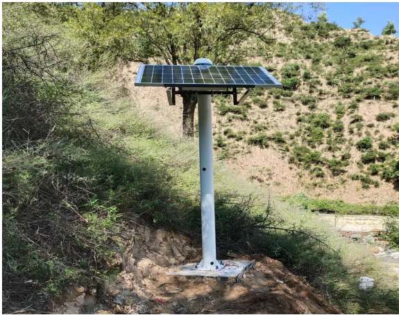
照片 5.6-1 GNSS 监测设备及接收机
