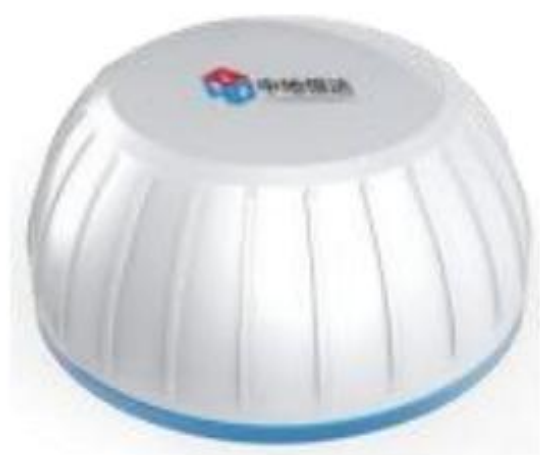
照片 5.6-1 GNSS 监测设备及接收机
