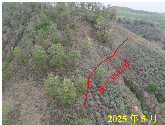
照片 3.2-19 地面塌陷 TX7 伴生地裂缝(镜向 NW) 照片 3.2-20 地面塌陷 TX7 损毁道路(镜向 NE)
