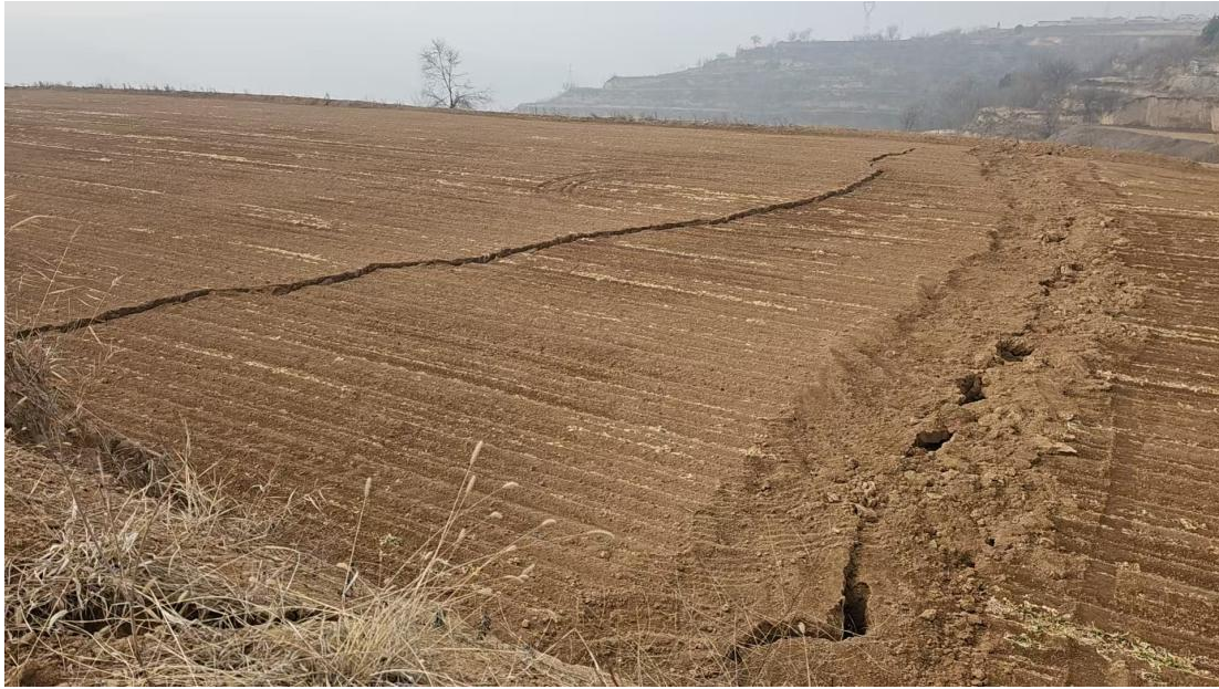
照片 2.40 大巷煤柱西工作面塌陷裂缝（镜像 140°）
