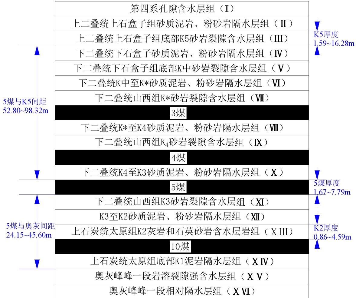
图 2.2-6 董东井田煤层与主要含（隔）水层位置有关系示意图
