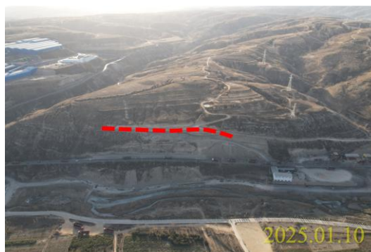
照片 3.2-11 庙羊路 K4+000 崩塌（镜向W）
