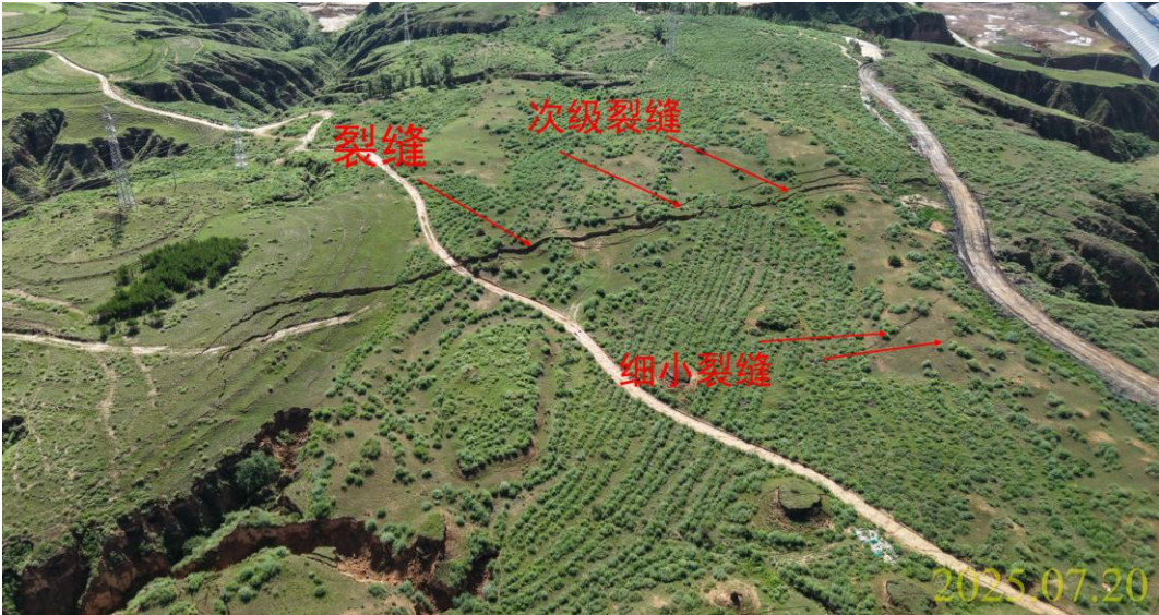
照片 3.2-22 地面沉降CX1 地面开裂（镜向E）
