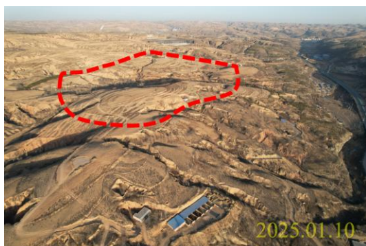
照片 3.2-1 红石塬地面塌陷（镜向 E）
