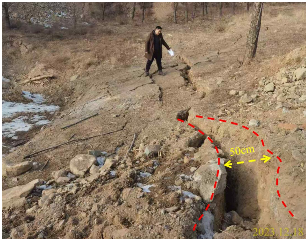
照片 3.2-28 521 盘区 5 -2 煤开采造成的地面沉陷
