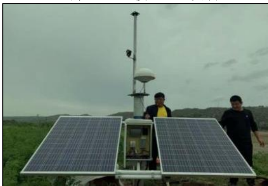
照片 5.6-6 野外 GNSS 基准点及太阳能系统
