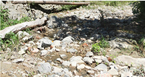
照片 2.2-2 洞口场地东桐峪河道内第四系全新统冲积层卵砾石（320°）
