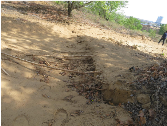
照片 3.2-1 塌陷区地表裂缝（镜向 W）
